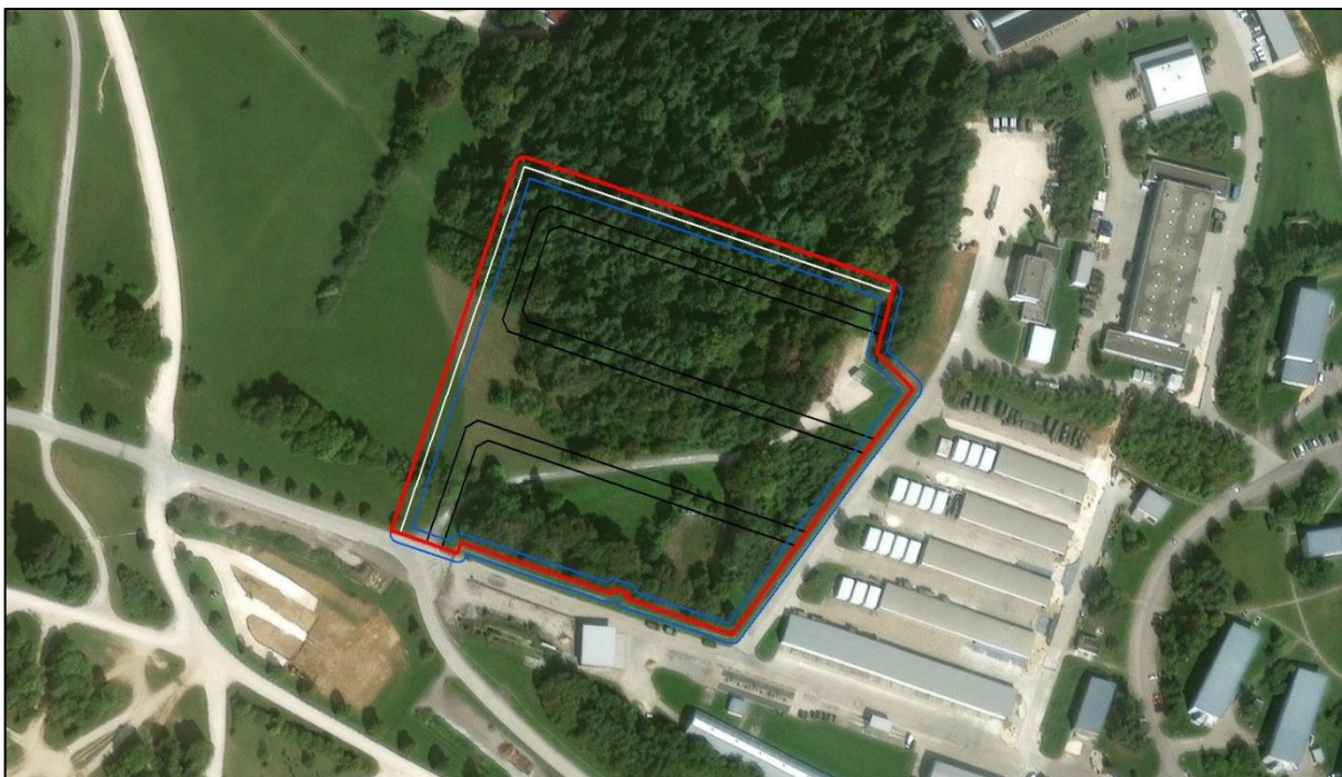
Abbildung 2: Lageplan des Bauvorhabens: Planbereich in Rot, Zaunverlauf in Weiß, Pufferbereich um Zaun in Blau, Fahrbahn in Schwarz (BUNDESBau BADEN-WÜRTTEMBERG 2025)
