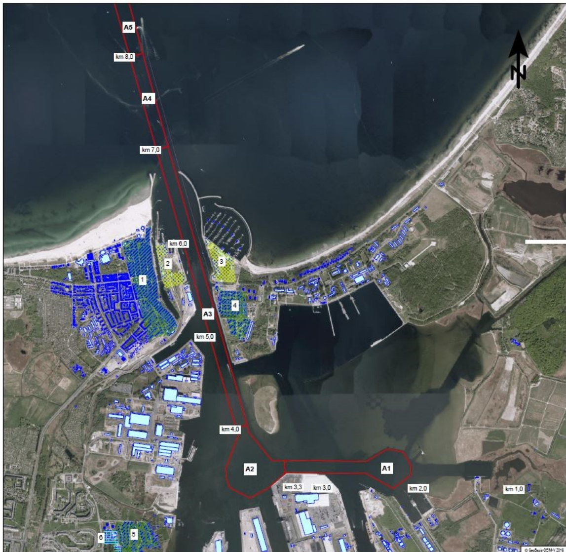
Abbildung 6: Darstellung der Bauabschnitte (Quelle: 11_07 Schallimmissionen, Teil 2 - Voruntersuchung baubedingte Schallimmissionen, Plan 1)
